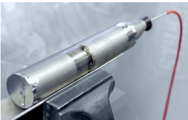
Sintermetall Formierfinger zum Formieren von Rohren
