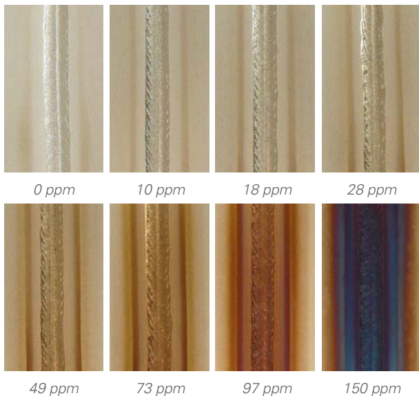
Einfluss des Restsauerstoffgehaltes auf das Formierergebnis
