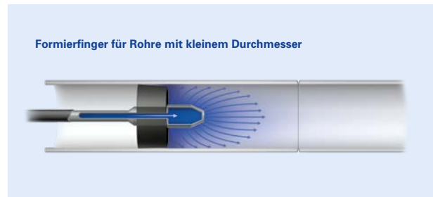
Formierfinger mit Stopfen zum Füllen von Rohren mit geringen Durchmessern
