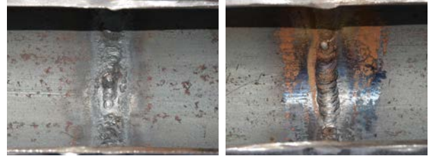
Bild links: Rohr aus Stahl: ohne Formiergas
