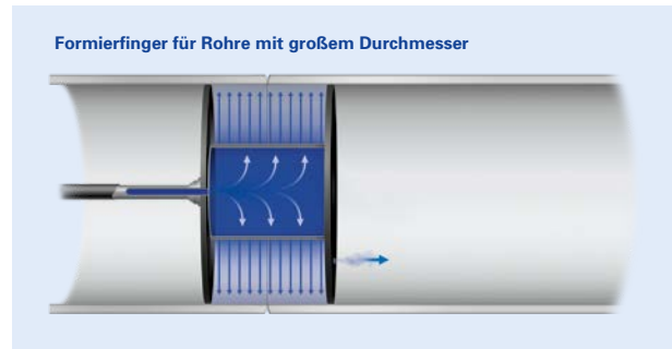
Eingrenzen des Formierbereiches durch einen Formierzylinder
