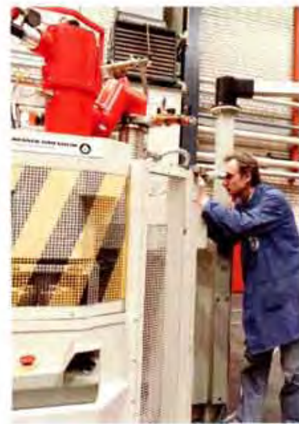
Während der Fertigung in der Vakuumkammer einer Elektronenstrahl-Taktanlage ist die Kontrolle über eine Optik möglich.
