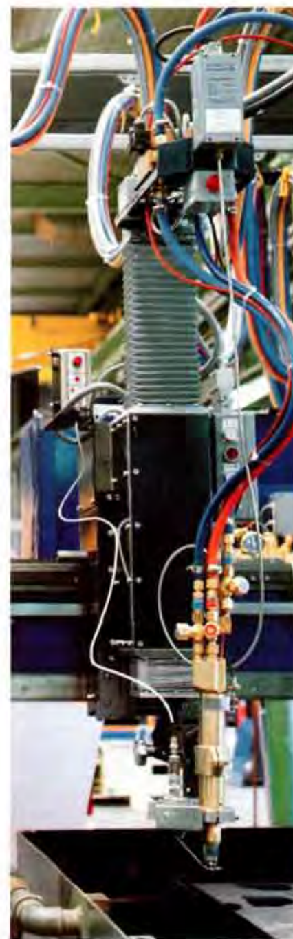
Sensoren überwachen und steuern die Brenner von computergesteuerten Schneidmaschinen.
