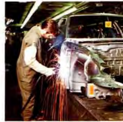
Zum Volkswagenwerk Emden haben wir alle MAG-Schweißanlagen auf Mischgas umgestellt.
