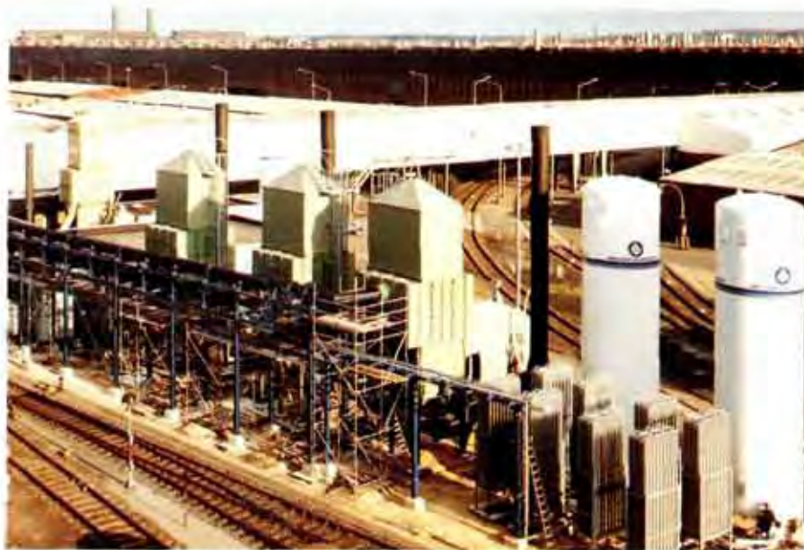
Die automatisch gesteuerte Fluoranlage bei VW entspricht den Richtlinien des Personen- und Emissionsschutzes. Das Abbleichen von Kunststoffbehältern aus Kunststoff dient dem Umweltschutz.
