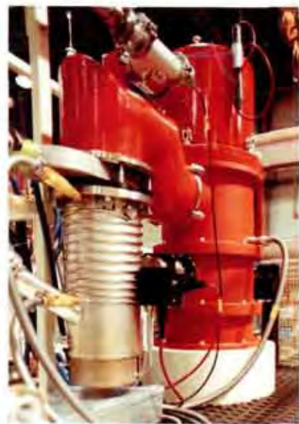
Der Generator ist das Kernstück jeder Elektronenstrahlmaschine. Er sorgt für Strahlstabilität und reproduzierbare Schweißungen.
