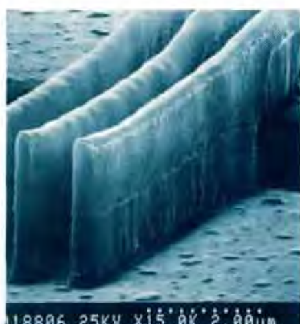
Ziel des JESSI-Programmes sind Halbleiterstrukturen im Submikrometerbereich, zum Beispiel 0,4 µm breit und 2 µm hoch. Die Aufnahmen zeigen ...
