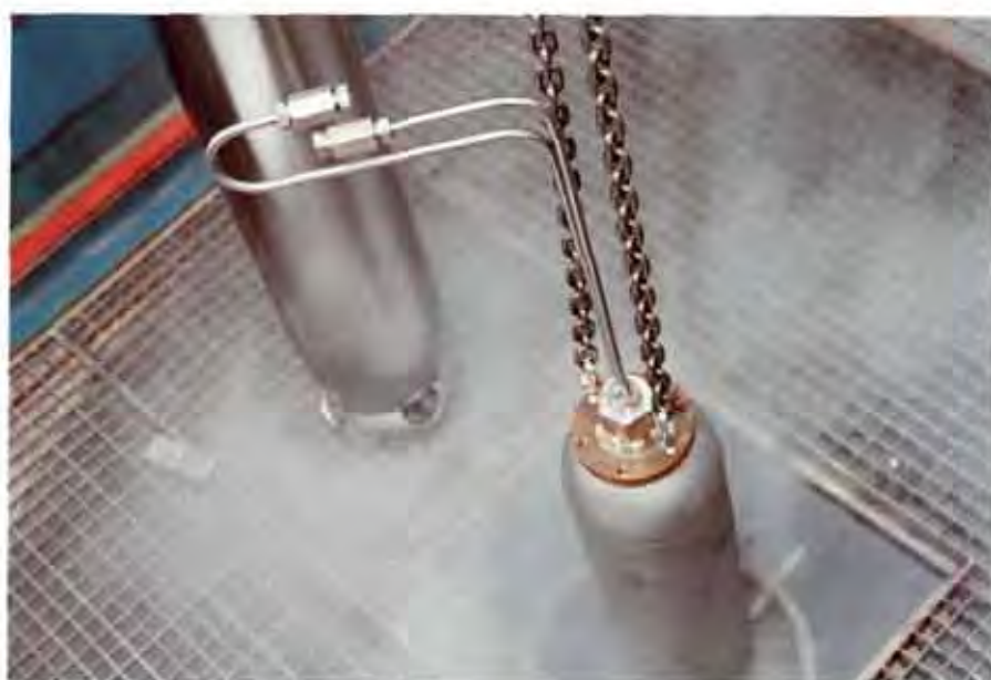
Das Stahlgefüge von Edelstahl-Hochdruckflaschen wird durch Kryostrecken im Flüssigstickstoff-Tauchbad verfestigt.
