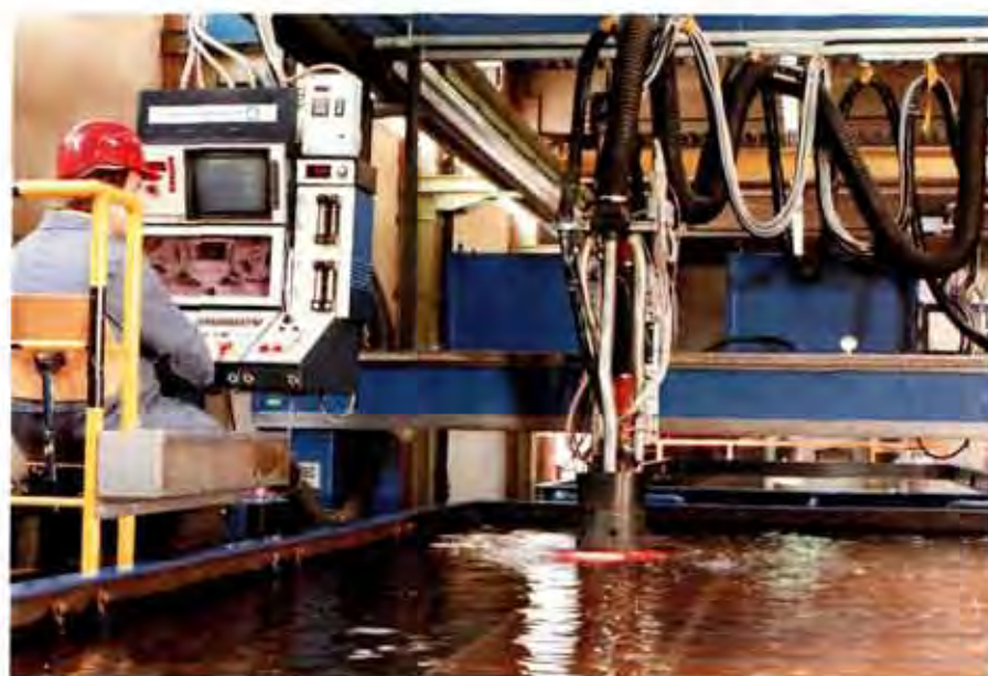
Unterwasser-Plasmamäschinen reduzieren den Wärmeeintrag in das Werkstück, um die Schadstoffe im Wasser abzusaugen. Lärm- und UV-Strahlung.
