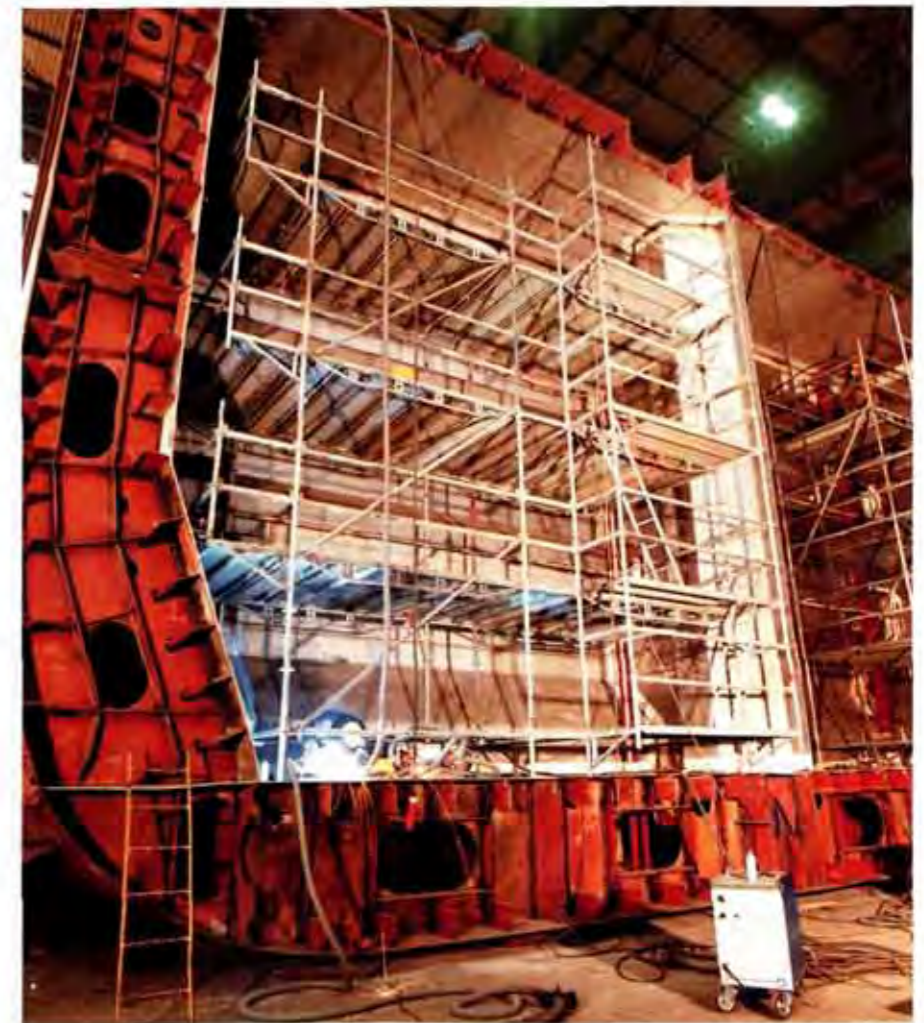
Für das Schweißen von hochfestem Duplex-Stahl haben wir Schweißschutzgasgemische entwickelt, mit denen Flüssiggasbehälter für Tanker gefertigt werden; zum Beispiel auf der Sürken-Wirt in Paternburg. Mit Mischgasen, Lichtbogenschweißgeräten und Schweißzusatzwerkstoffen bieten wir geeignete Systemlösungen an.
