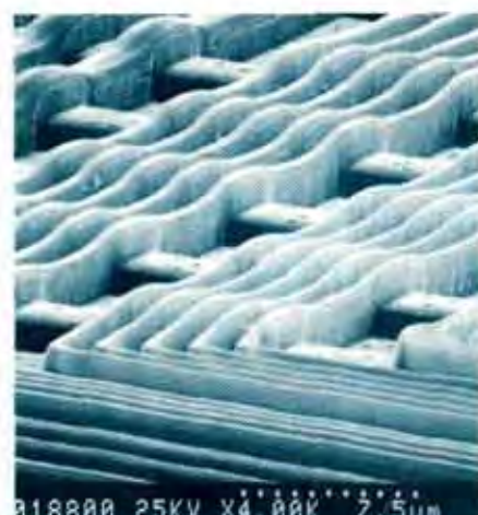
... Leiterbahnen aus Aluminium, die mit Röntgenstrahlen präpariert wurden. Industrie und Wissenschaft arbeiten an den Grenzen heutiger Halbleitertechniken.
