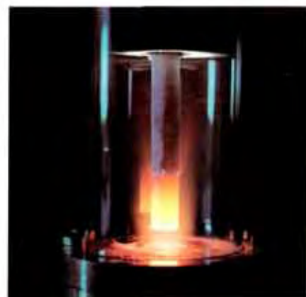
Materialprüfung unter extremen Bedingungen: Am Institut für Industrietechnik der Technischen Hochschule Aachen wird die Anströmung eines Zylinders aus Siliziumkarbid im Argon-Plasma bei 4000 K simuliert
